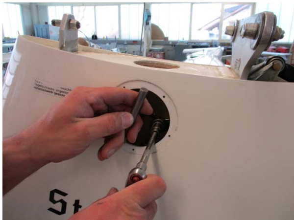
HR-Stange durch Handlochdeckel lösen und mittels Schnur durch die Bohrung nach oben herausnehmen Loosen elevator pushrod through control openings and remove upward through cut hole using a string
