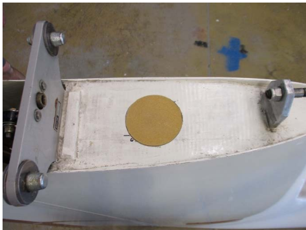
Ausschwenken mit Korrosionsschutz und Einsetzen neuer Rohrniet Rinsing with corrosion preventive and insert new tubular rivet
