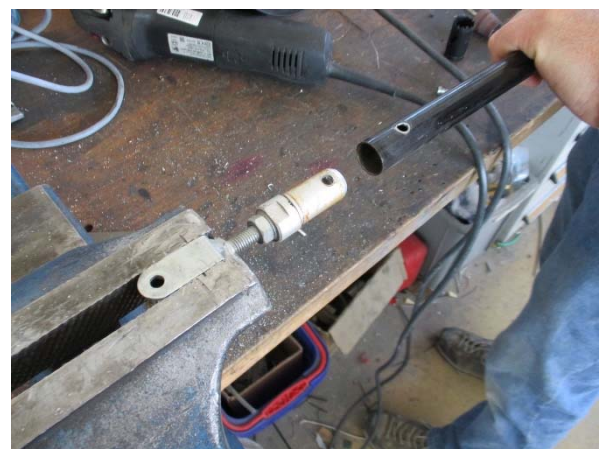
Ausbohren des Rohrniets (Bohrer Ø 6 mm) und Herausziehen der Alu-Buchse mit dem Gabelkopf Drilling out the tubular rivet (drill Ø 6 mm) and pulling of the aluminum bush with the fork end
