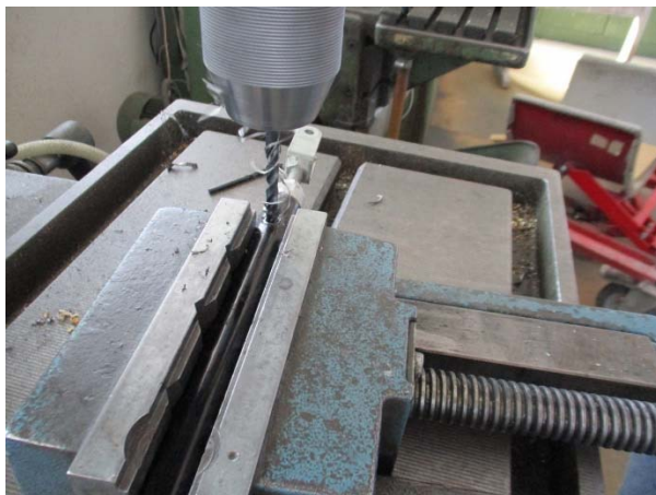
Ausbohren des Rohrniets (Bohrer Ø 6 mm) und Herausziehen der Alu-Buchse mit dem Gabelkopf Drilling out the tubular rivet (drill Ø 6 mm) and pulling of the aluminum bush with the fork end
