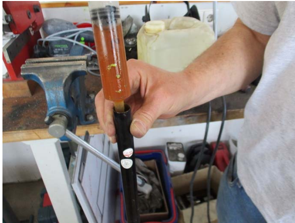
Ausschwenken mit Korrosionsschutz und Einsetzen neuer Rohrniet Rinsing with corrosion preventive and insert new tubular rivet
