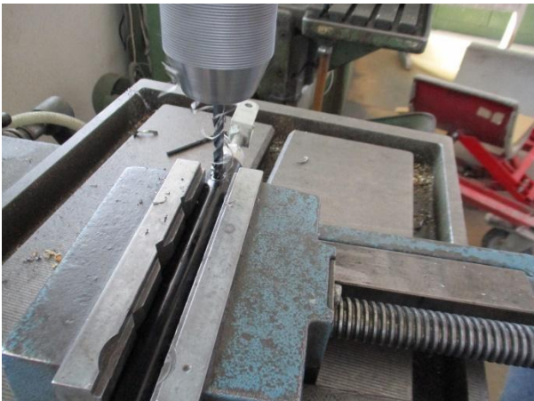
Ausbohren des Rohriets (Bohrer Ø 6 mm) und Herausziehen der Alu-Buchse mit dem Gabelkopf Drilling out the tubular rivet (drill Ø 6 mm) and pulling of the aluminum bush with the fork end
