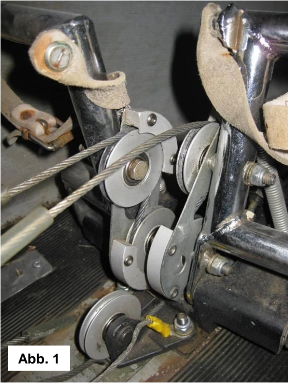
Abb 3 / 4 – Pedaleinheit: geschlossener Seilkäfig, weiße Kunststoff-Rollen (Austausch notwendig) Pedal unit: closed cable cage, white plastic pulleys (replacement needed)
