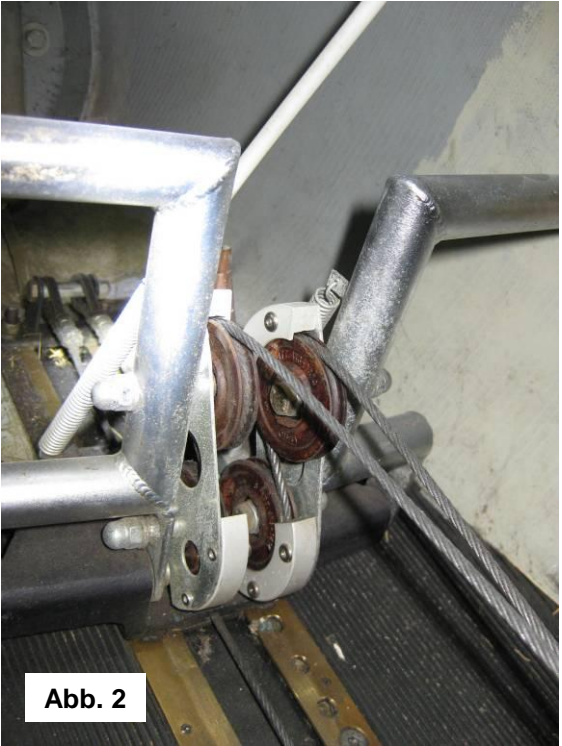
Abb 3 / 4 – Pedaleinheit: geschlossener Seilkäfig, weiße Kunststoff-Rollen (Austausch notwendig) Pedal unit: closed cable cage, white plastic pulleys (replacement needed)
