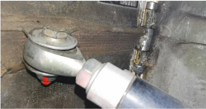
Abb 5 – SR Antriebsrippe im installierten Zustand im Seitenruder; Ansicht bei nach links ausgeschlagenem Ruder durch Öffnung auf rechter Seite (Pfeil in Skizze) rudder drive plate installed in the rudder; view when rudder fully deflected to the left side through opening on right side (arrow in sketch)
